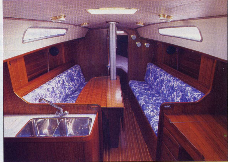
Molto lineare il disegno della dinette, formata da due panche contrapposte per un totale di sei sedute. L'essenza degli interni è il teak.
